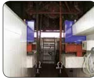
Hydraulische Niederzugvorrichtung zur Last-Simulation
